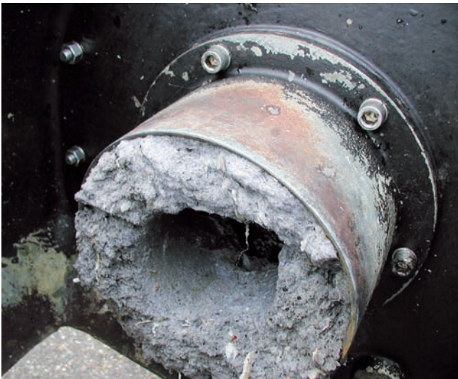
Strainpress mit Verstopfung (5.8.2)
