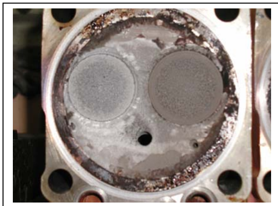
Abbildung 14: Schaden an BHKW
