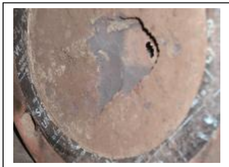
Abbildung 12: Stahldeckel mit Abrasionsloch
