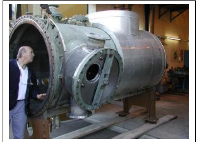
Abbildung 11: Revidiertes Trocknergehäuse vor Einbau
